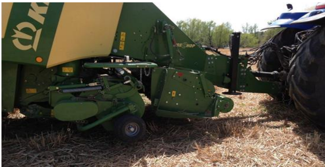
Рисунок 23. Крупный план машины Krone ViG Pack 1290 HDP XC вместе с PreChop, закрепленному к трактору.
