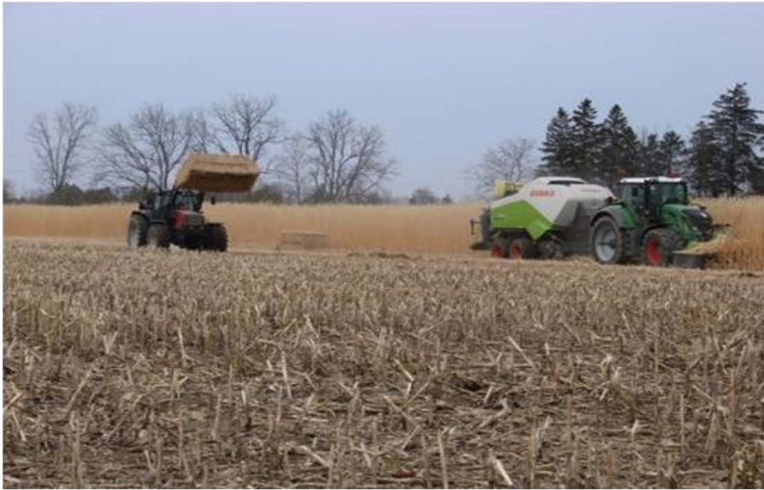
Рисунок 22. Передненавесная дисковая косилка сразу с прессованием мискантуса на насаждении второго года. Полученная урожайность 13,2 т/га (6 тонн сухой массы/акр).
