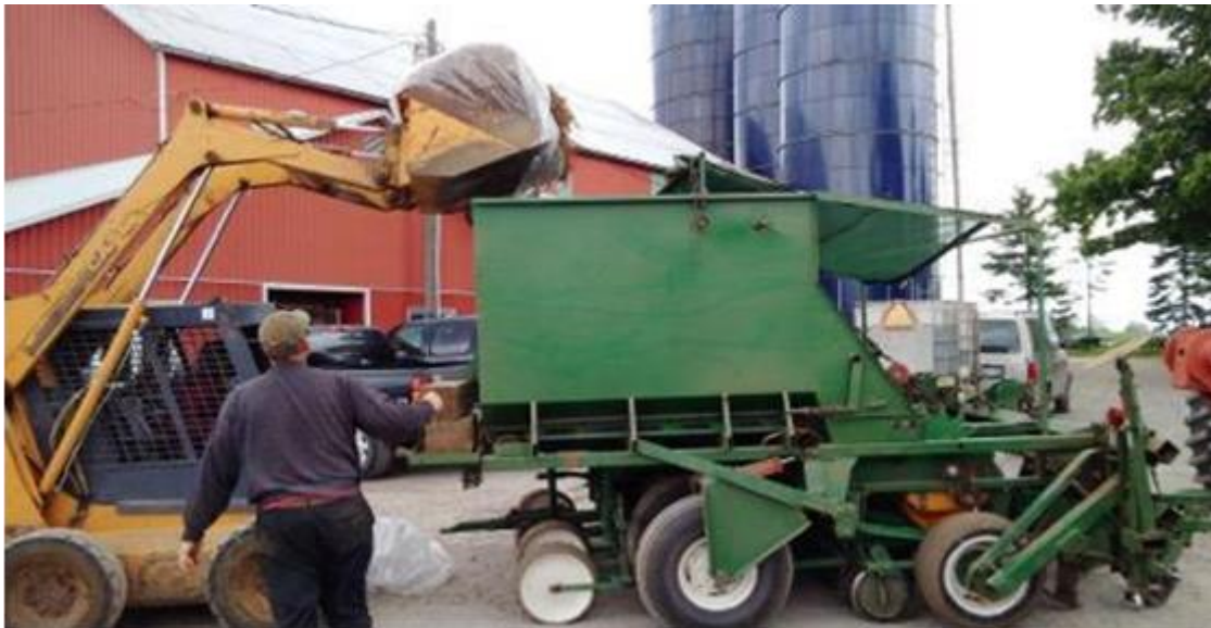
Рисунок 14. Прототип беспашотной посадочной машины, разработанной Д.Смитом, заполняемой ризомами до посадки.
