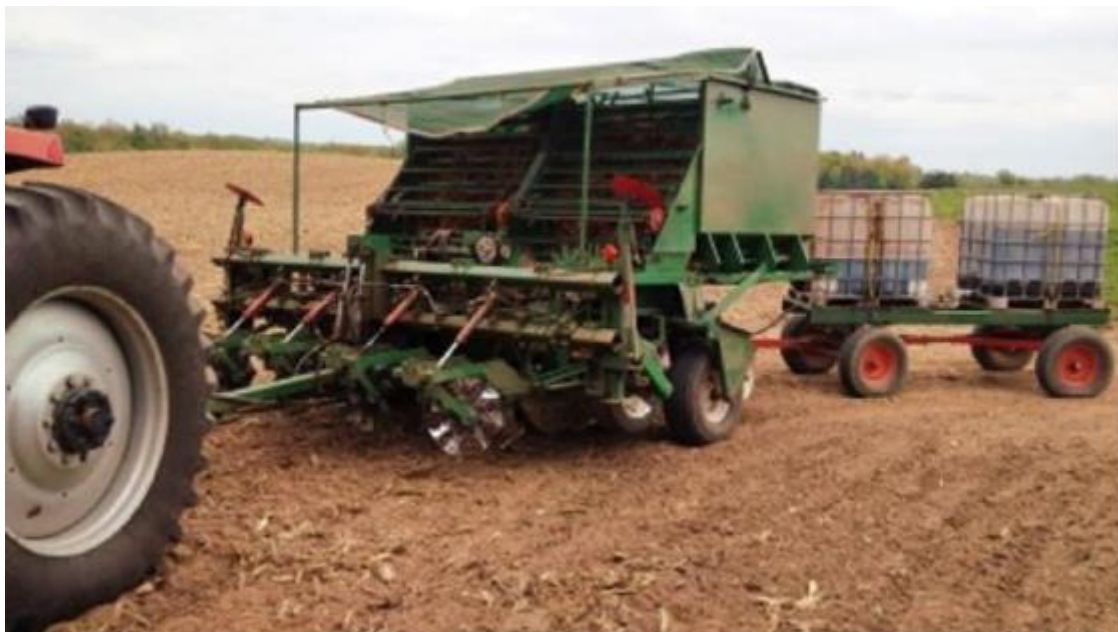
Рисунок 15. Беспашотная посадочная машина, разработанная Д.Смитом, с цистерной предпосадочного удобрения, прикрепленного веревкой. Сошник для уборки остатков спереди посадочной машины.
