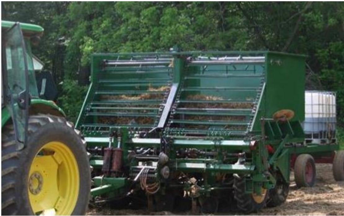
Рисунок 10. Прототип беспашотной посадочной машины, разработанной в Онтарио Д.Смитом (All Weather Farming).
